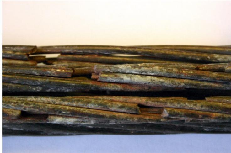
Abbildung 2: Im Zuge der Belastung gebrochene Spanndrähte; siehe Müller, Szugat und Maurer 2016.
