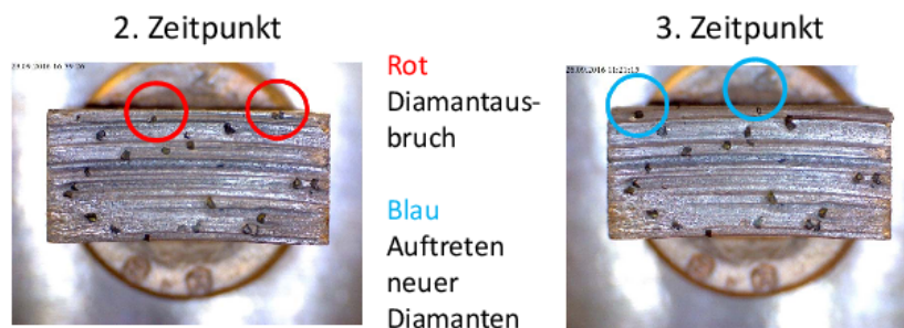
Abbildung 1: Darstellung eines Bohrsegments zu zwei aufeinander folgenden Zeitpunkten, zwischen denen zwei Diamanten ausgebrochen und zwei Diamanten neu hinzugekommen sind
